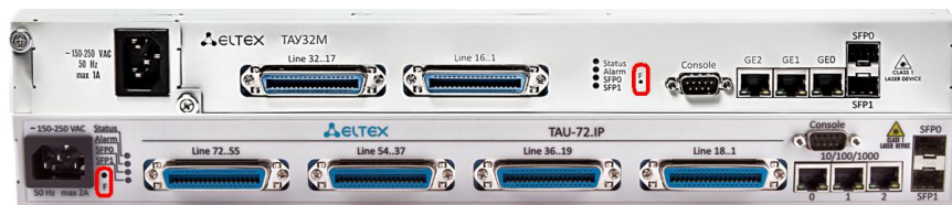
Рисунок 3.3 – Положение функциональной кнопки F
