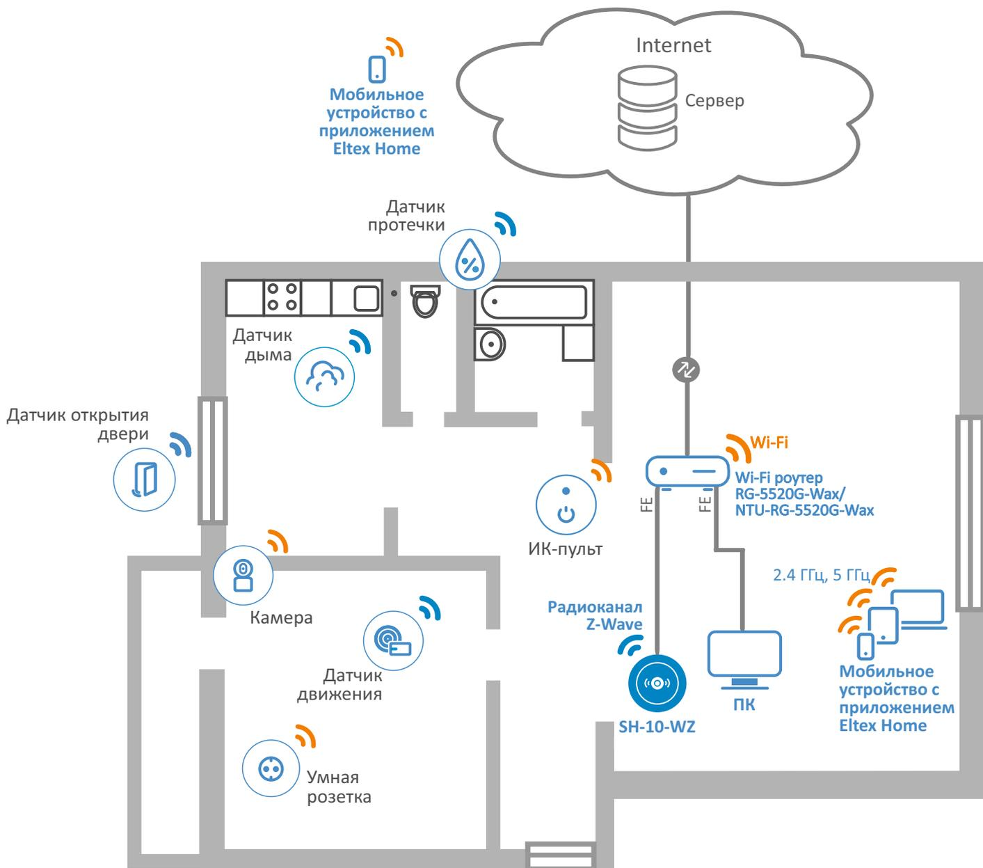
Схема работы SH-10-WZ при беспроводном подключении
