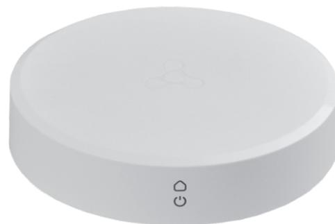
**SH-10-WZ** — хаб умного дома Eltex Home, предназначенный для организации единой системы управления, конфигурирования и мониторинга умных устройств Eltex.
