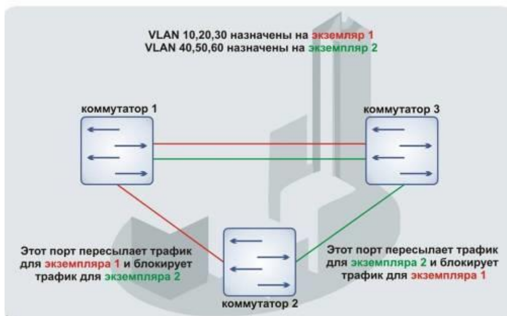
Рисунок 31— Настройка протокола множества связующих деревьев
