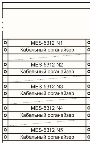
Рисунок 81 – Размещение коммутаторов MES5312 в стойке
