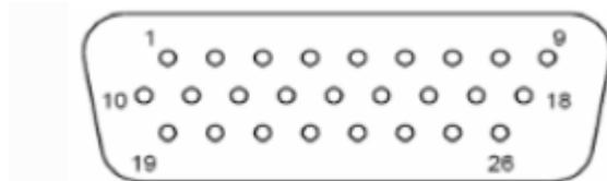
Рисунок 2 – Распиновка разъема на передней панели
