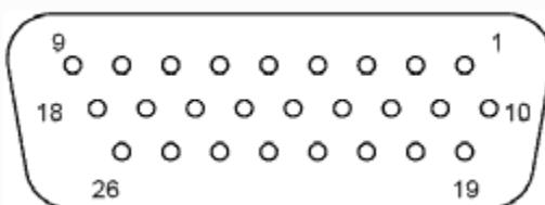
Рисунок 3 – Распиновка разъема на ответной части
