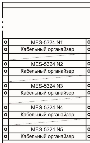
Рисунок 46 — Размещение коммутаторов MES5324 в стойке
