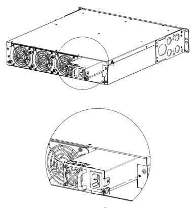
Рисунок 27 — Установка блоков питания
