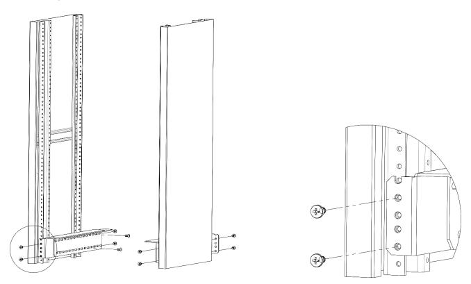
Рисунок 28 — Установка направляющих полозьев в стойку
