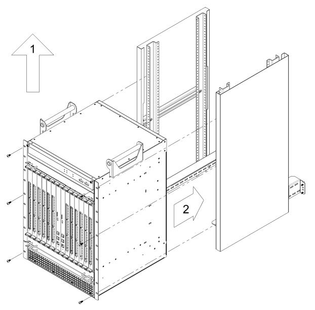
Рисунок 30 — Установка шасси МЕ5000, МЕ5000М в стойку
