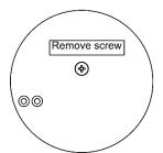
Рисунок 29 — Боковая панель шасси МЕ5000, МЕ5000М с транспортировочными винтами
