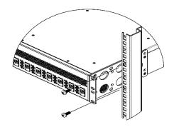
Рисунок 26 — Установка устройства в стойку
