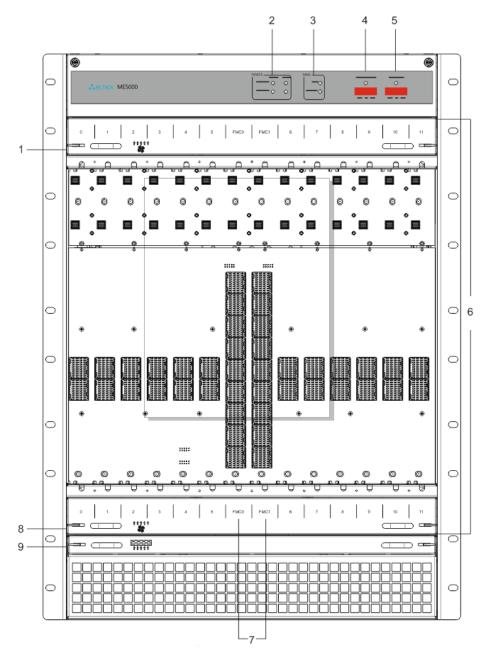
Рисунок 6 — Передняя панель МЕ5000, МЕ5000М (шасси)
