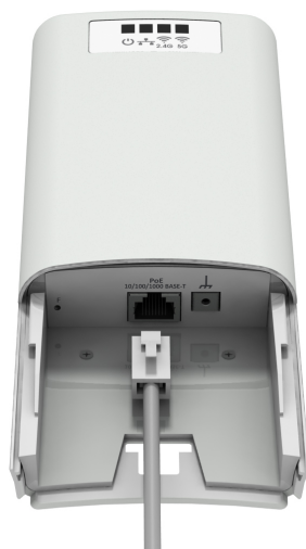
Рисунок 14 – Подключение Ethernet-кабеля к PoE-порту
