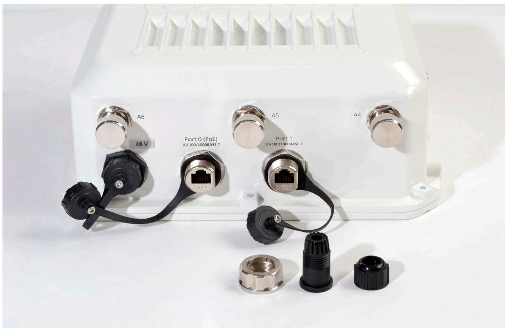
Рисунок 11 – Герметичный разъем RJ-45 на устройстве и ответная часть в разобранном виде
