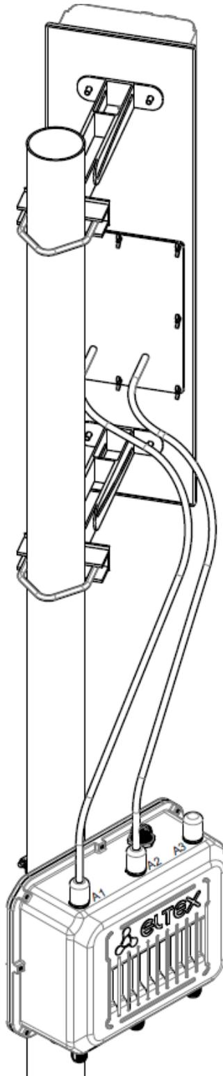
Рисунок 28 – Схема подключения антенны к устройству
