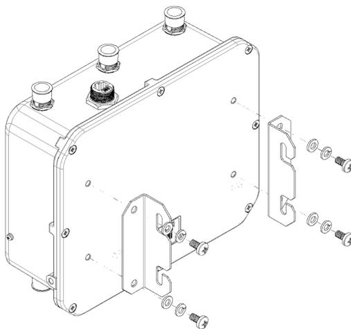
Рисунок 4 – Крепление кронштейнов к устройству
