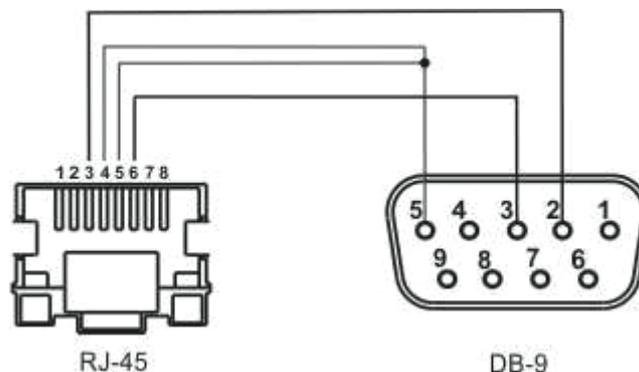
**Шаг 1.** При помощи консольного кабеля соедините порт **CONSOLE** точки доступа с COM-портом компьютера. Для работы консольного кабеля могут потребоваться драйвера в зависимости от операционной системы компьютера.
