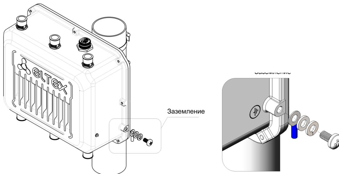
Рисунок 26 – Схема заземления устройства
