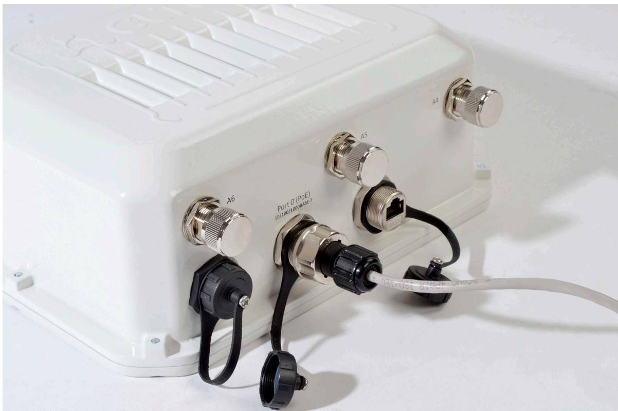
Рисунок 16 – Вид подключенного кабеля к сетевому интерфейсу устройства
