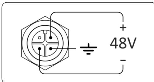
Рисунок 27 – Распайка питания 48V разъема корпуса
