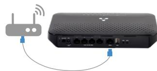
Если в стороннем роутере используется подсеть 192.168.1.0/24, то при подключении RG-1440G-Wac его LAN IP-адрес автоматически изменится на 192.169.2.1.
