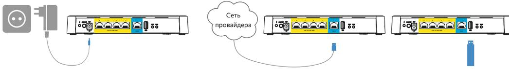
Для работоспособности модемного соединения Ethernet-кабель должен быть отключен из WAN-порта.
