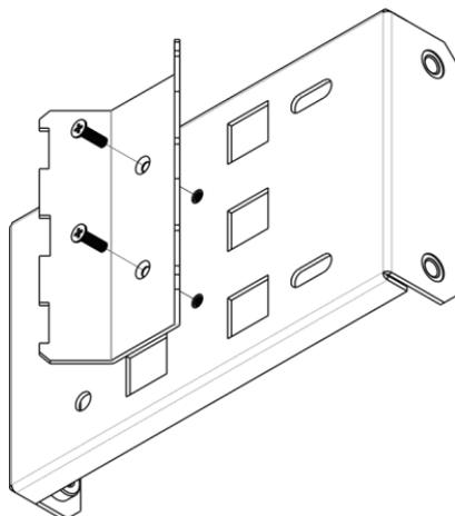
Рисунок 3 – Кронштейн для крепления на трубостойку
