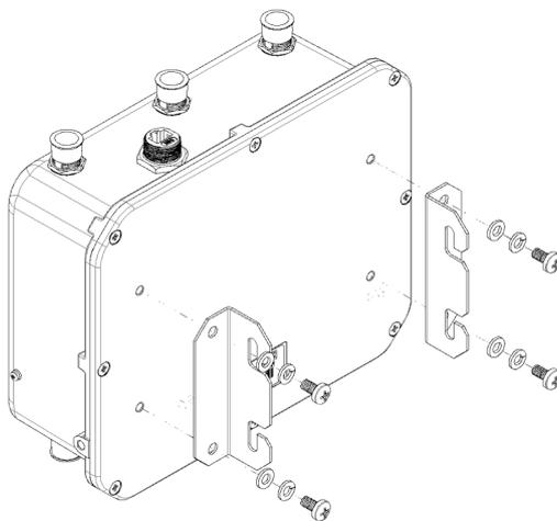
Рисунок 2 – Крепление кронштейнов к устройству
