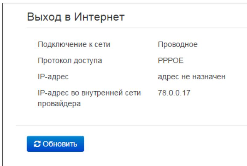
Если устройство не получило адрес во внутренней сети провайдера (четвертая строчка), это означает, что либо устройство не имеет доступа к внешней сети (проверьте индикатор WAN – если он не горит, значит проблемы с кабелем), либо в сетевых настройках RG-4402-G был неправильно настроен VLAN.
